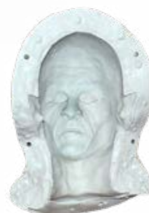
In assenza di sottosquadra o nel caso di manufatti realizzati in silicone, è possibile creare stampi rigidi con le resine poliuretatiche Smooth-cast e Shell Shock .
