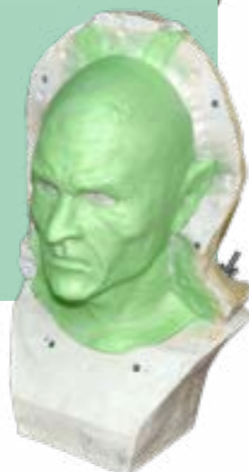
In assenza di sottosquadra o nel caso di manufatti realizzati in silicone, è possibile creare stampi rigidi con le resine poliuretatiche Smooth-cast e Shell Shock .
