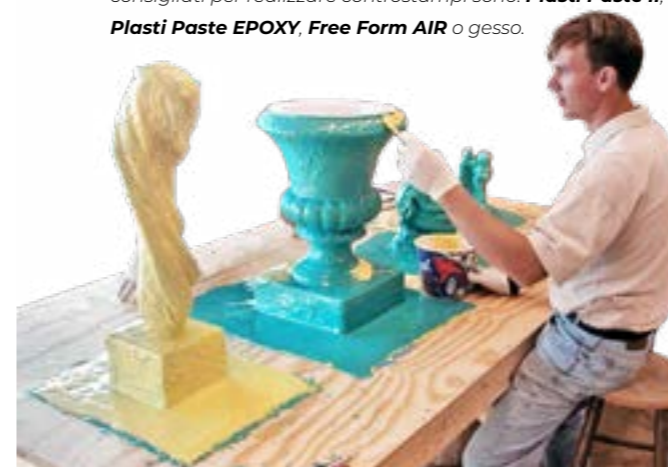
L'aggiunta di un pigmento permetterà di differenziare i vari strati, di gomma poliuretanica e siliconica, che vengono man mano applicati sul modello. Questo, al fine di comprendere dove è già stato applicato il materiale.
